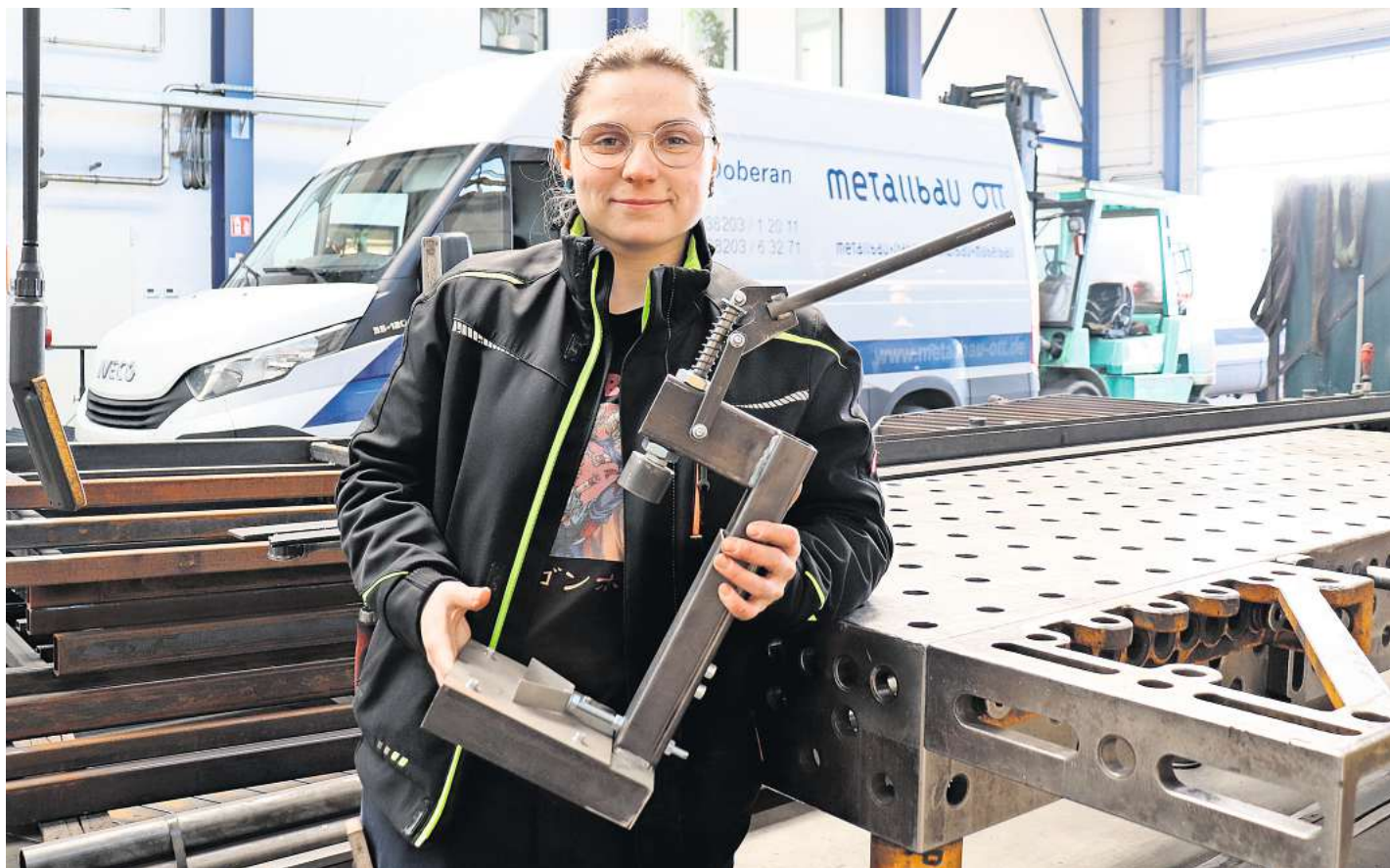
Lea Gottschanderl aus Bad Doberan baute in ihrer Gesellenprüfung ein Flaschenverschließgerät für Kronkorken.
